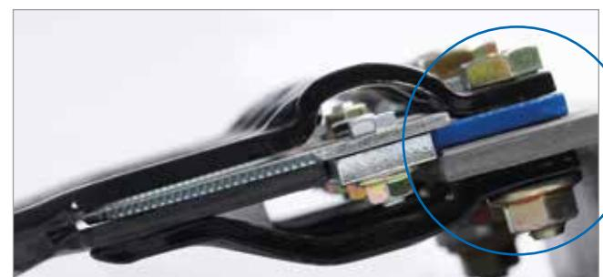
Beidseitig verschraubte Stahl-Mähfinger für eine hohe Stabilität
