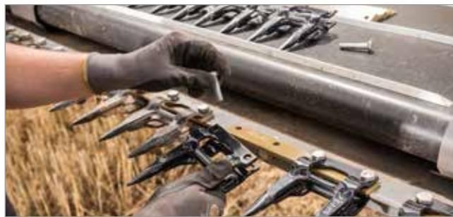
Schneller Ersatzteilaustausch durch komplett geschraubte Komponenten
